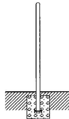
Les dimensions des massifs béton portées sur ce plan sont données pour un sol meuble. Sport France se réserve le droit de modifier celles-ci pour les adapter suivant la nature du sol.
